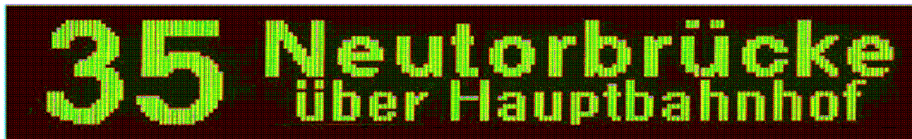
Anzeige 1 (LCD; Auflösung 26x192 Pixel)
