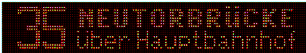
Anzeige 3 (LED; Auflösung 16x120 Pixel)
