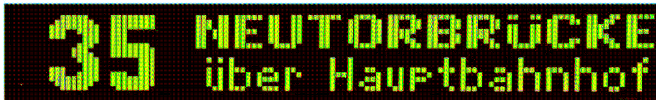
Anzeige 2 (LCD; Auflösung 16x112 Pixel)
